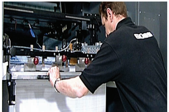
Einschieben der zweiten Platte des Stapelmechanismus bei laufender Maschine
