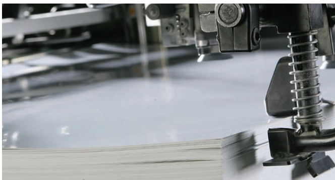
Sistema de entrada convencional de papel hacia la máquina de imprimir de hoja
