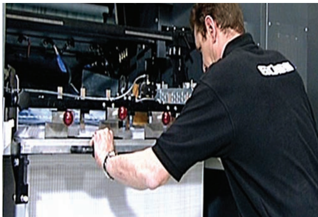
Inserción de la segunda base del mecanismo de apilado mientras la rotativa está funcionando
